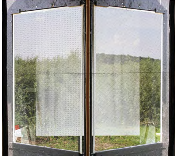
Trotz geringer Punktabstände unwirksames Punktraster: ein dichtes Raster aus schwarzen Punkten mit 3 mm Durchmesser wurde auch auf Position 1 von Vögeln nicht erkannt (links Prüf-, rechts Referenzscheibe).
