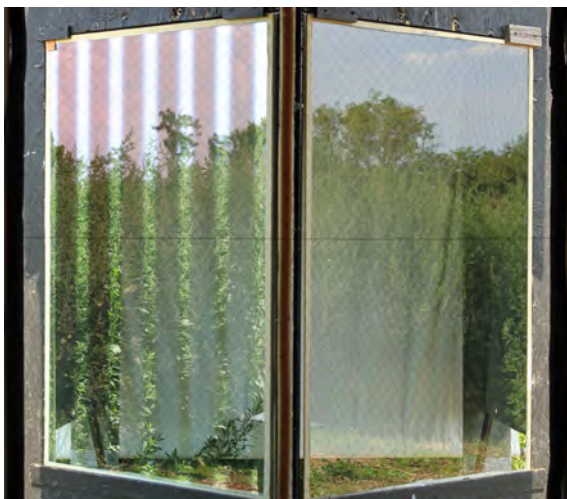
Sicht des Vogels im Versuchstunnel. Pilkington AviSafe™ Aussenansicht: als Schutz vor Vogelanzug hoch wirksam, vom Innenraum aus kaum sichtbar (links Prüf-, rechts Referenzscheibe).
