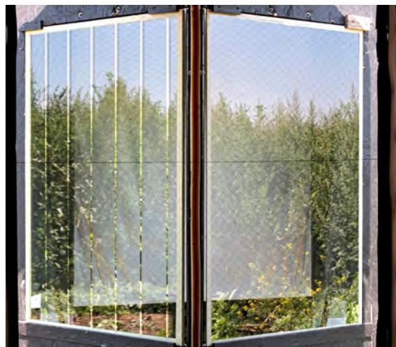
Arnold Glas Orniflux® design lines 5/95: hoch wirksame Metallmarkierung mit klassischem Streifenmuster (links Prüf-, rechts Referenzscheibe).
