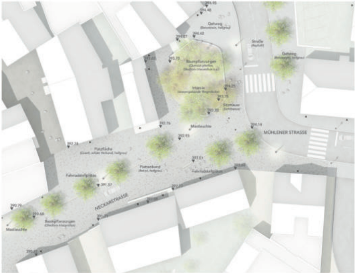
Lageplanabschnitt Einmündungsbereich Neckarstraße - Mühlener Straße M 1:200
