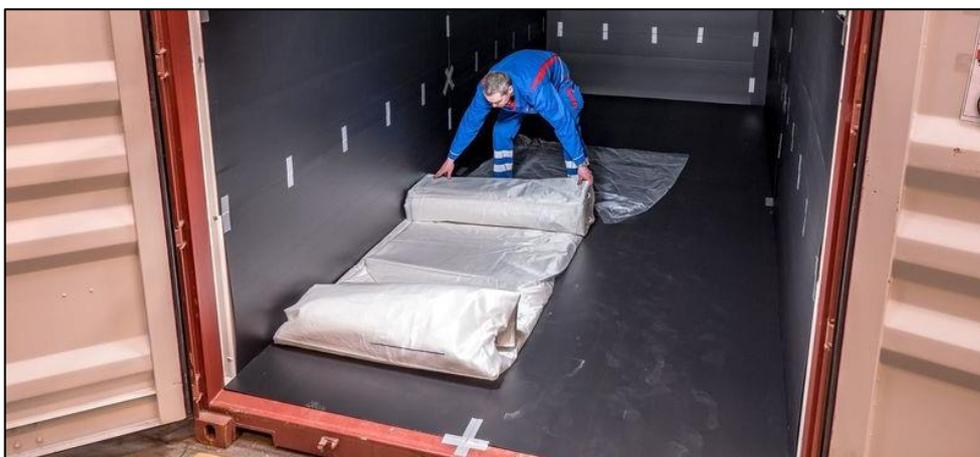
Abbildung: Einbau eines Flexitanks (Beispiel)
