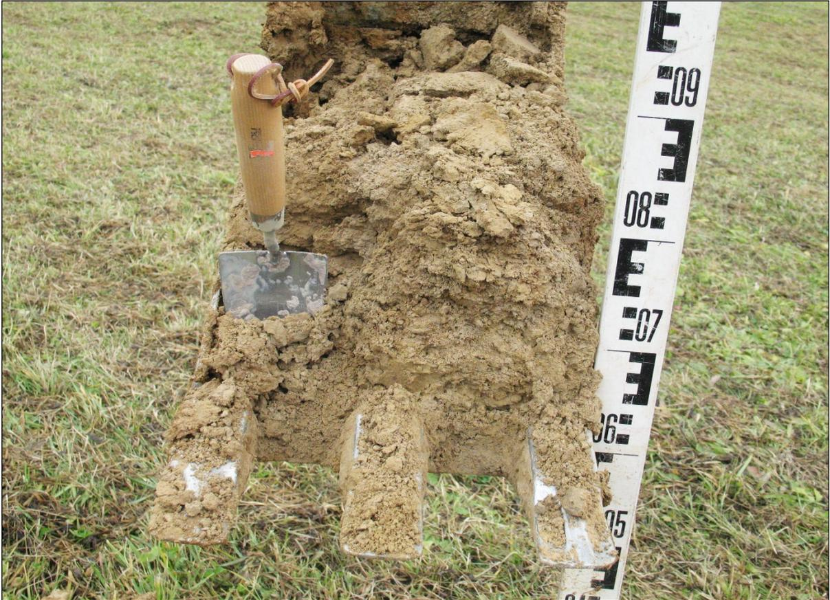
Foto 1: Schurf S 1: Völlig zu Feinsand zersetzter oder zerscherter Kalk(stein) aus dem Tiefenbereich ca. 2,0-2,2 m u. GOK (Foto: 06.11.2017 HTR/TR)
